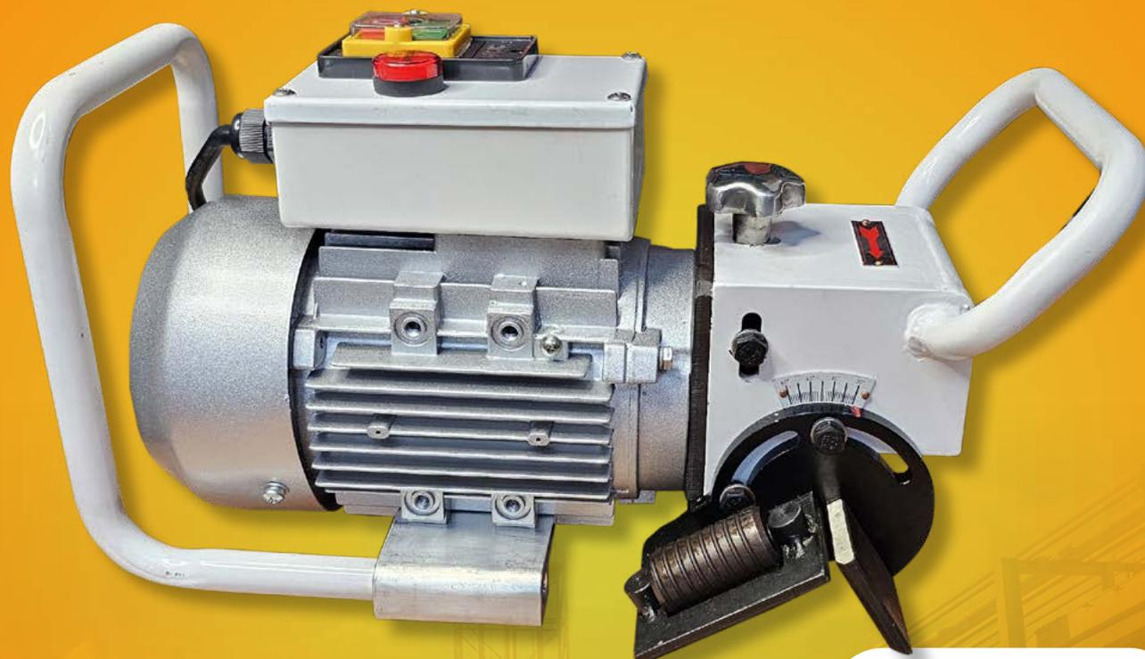
A **CHANFRADEIRA** manual **NOMAQ** trabalha no ângulo de chanfros 15° a 45° em chapas de aço com espessura de até 15 mm. A máquina de chanfrar é de fácil operação, têm alça ergométrica, guiada por roletes e oferece excelente desempenho e qualidade no acabamento final.
